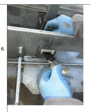
Gurte mit Haken <u>über</u> die Rolle bei der Serviceöffnung durchziehen
